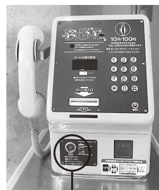
緊急通報ボタン
